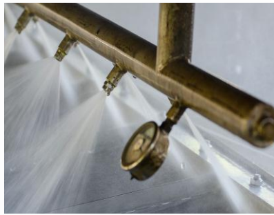
Limpieza a presión de la malla del filtro.
